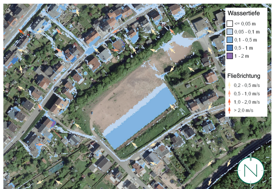
Starkregengefahrenkarte ( N_{100} ), Saarland - Wassertiefen und Fließrichtung; Grundlage: © GeoBasis-DE/LVGL-SL (2026); Bearbeitung: Kernplan GmbH
