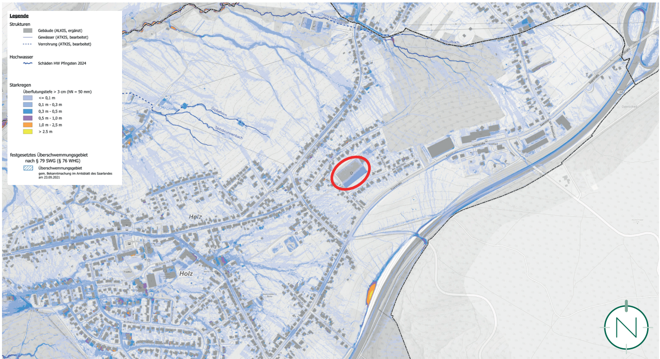
Starkregengefahrenkarte für das Ereignis 50 mm/1h (ca. T=100 a) für den Ortsteil Holz; Quelle: eepi GmbH, Merzig und ingGIS, Merchweiler; Stand: 28.04.2026, Entwurf
