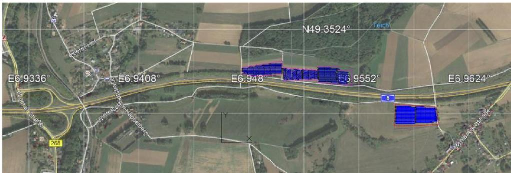
Abbildung 1: Lage der Modulreihen (blau), der Autobahn A 8, der Landesstraße L 268 sowie der Häuser an der Mehlenbachstraße im Südosten
